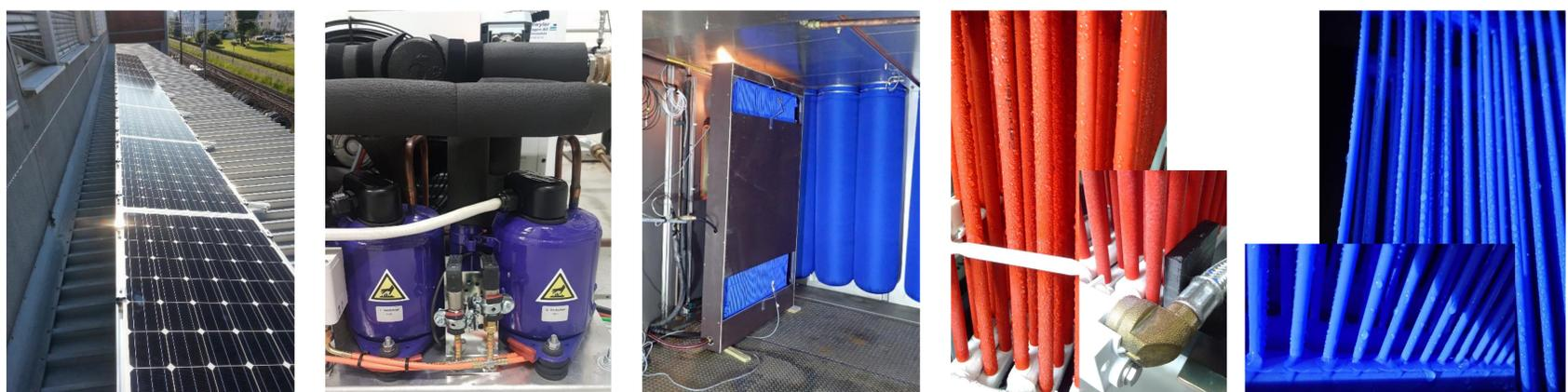
Abbildung 3: System- und Komponenten-Aufbau in Labor: PV-Anlage mit 2.5 kW Peak-Leistung auf den Vordach, Kompressor-Cluster mit zwei Kompressoren ( $P_{cool}$ : 1.6 kW & 2.5 kW), Kälteverteilung mit Kühlkästen (in Klimakammer zur Charakterisierung der Kälteverteilung), Kondensation auf den Kühlregistern.
