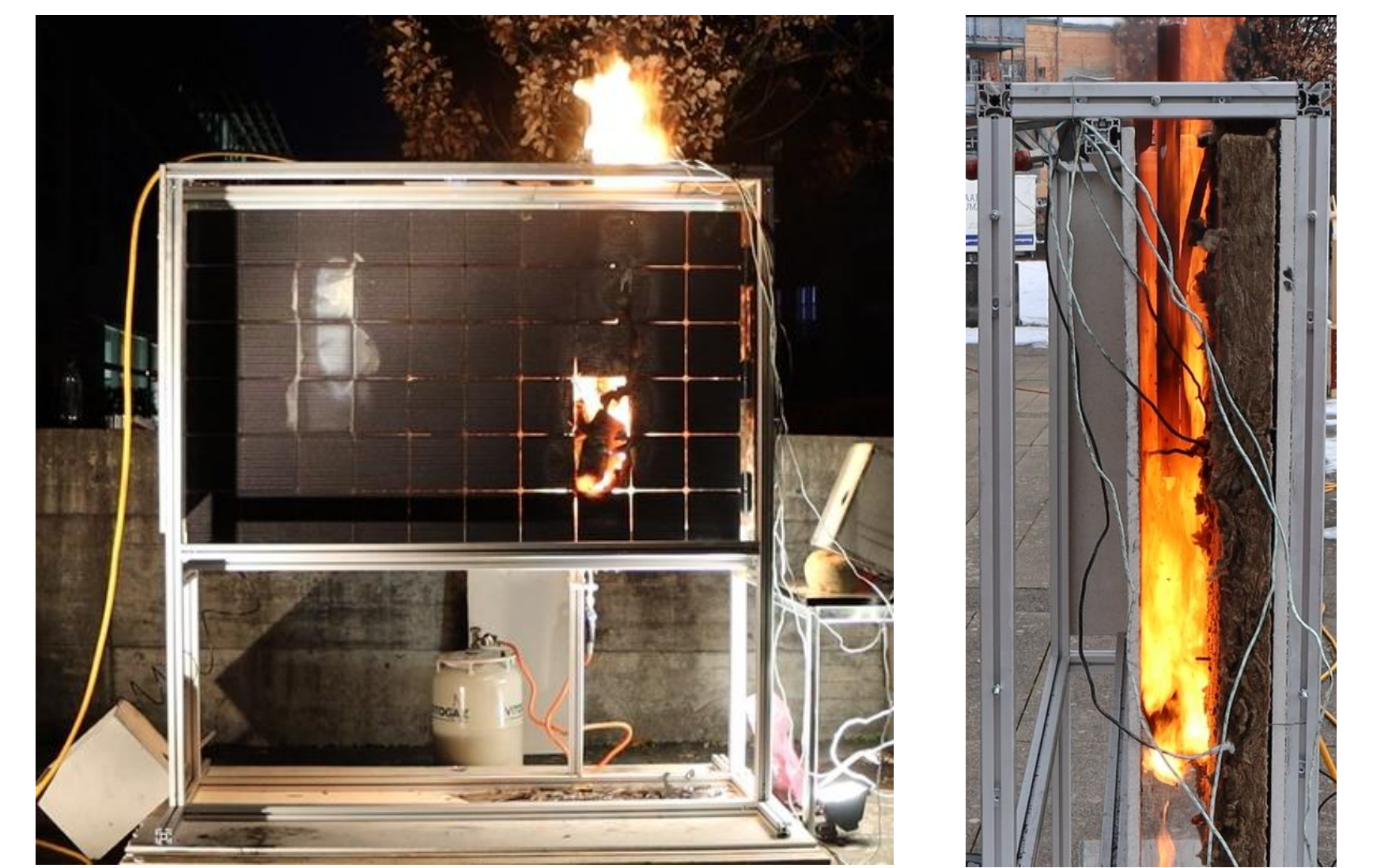
Abbildung 4 & 5: Flammenversuch im Fassadenprüfstand
