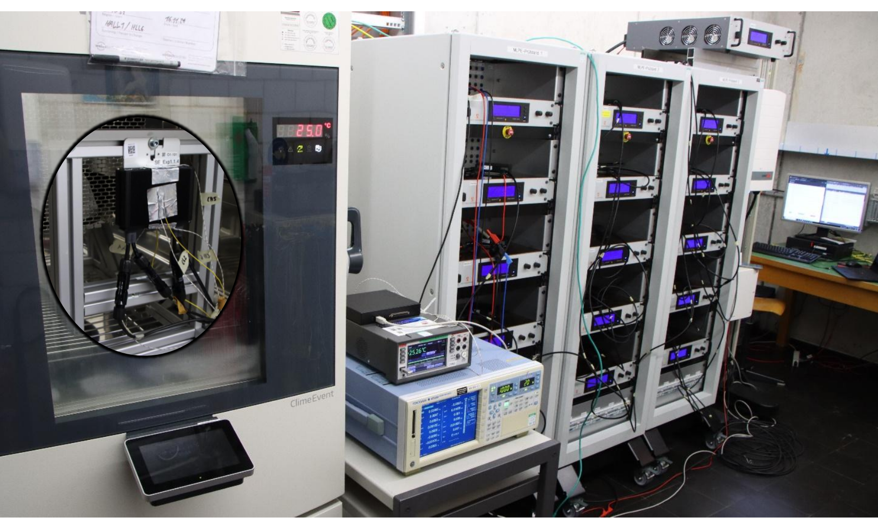
Abbildung 1: Laboraufbau Gesamtsystem Experimentreihe 1 mit Übertemperaturen bis 180° C
