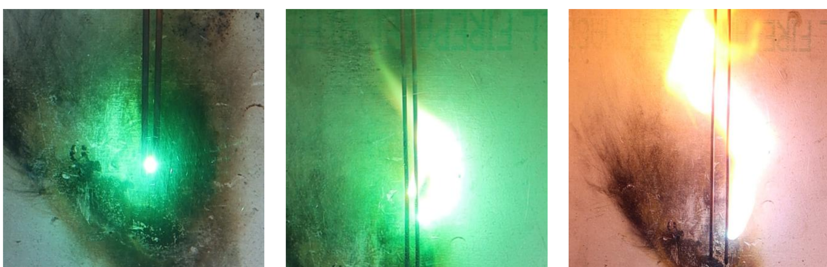
Abbildung 2: Verschiedene Lichtbögen bei blanken Leitern
