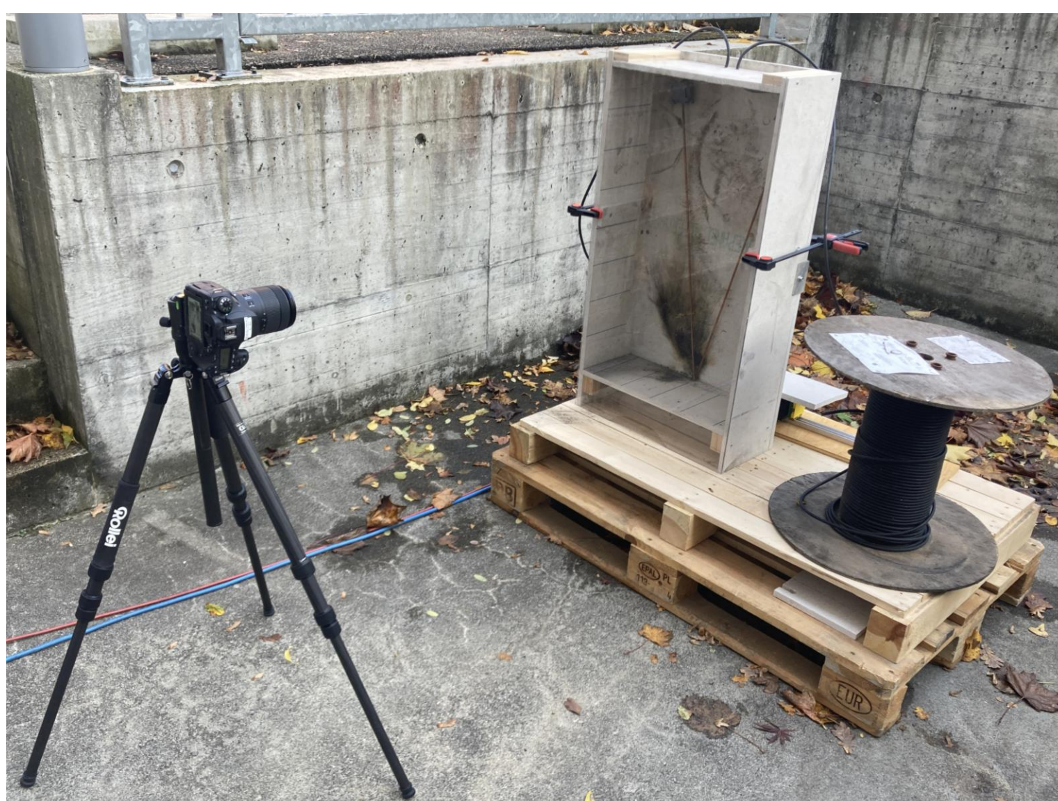
Abbildung 1: Versuchsaufbau für die Lichtbogenversuche
